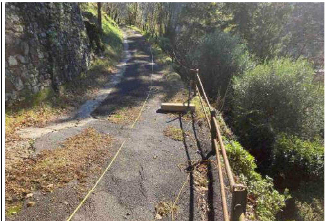
**Foto n.3** – Colpo intermedio sinistro **D1** del profilo sismico “TRESANA 1-1” posizionato lungo il ciglio stradale della viabilità asfaltata; fase di energizzazione con onde SH.
