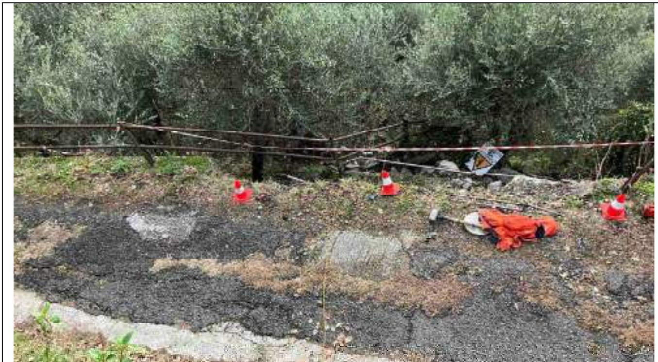
**Foto n.5** – Colpo centrale **C** del profilo sismico "TRESANA 2-2'" con onde P disposto lungo la linea di massima pendenza.
