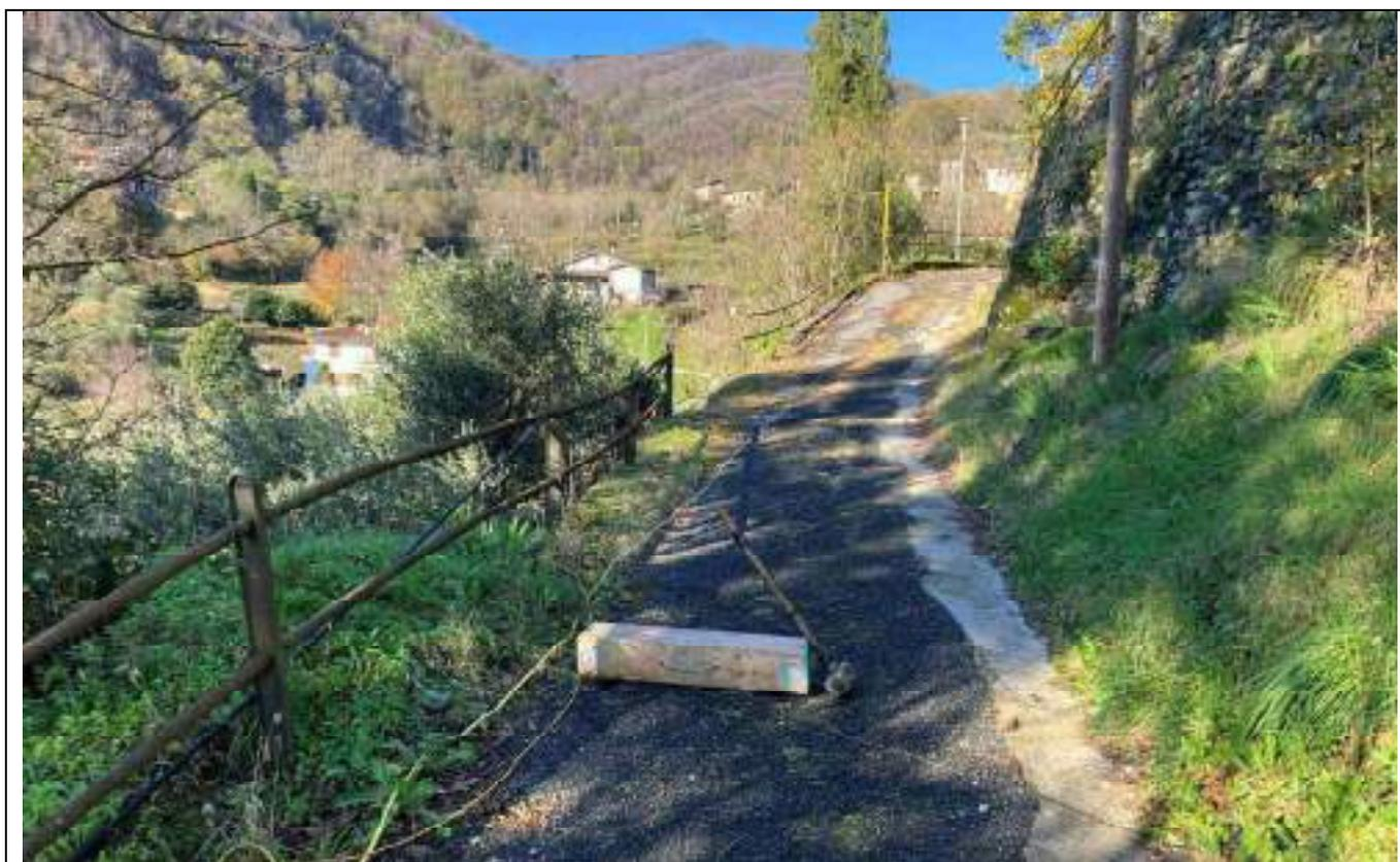
**Foto n.4** – Colpo intermedio destro **D2** del profilo sismico “TRESANA 1-1” posizionato lungo il ciglio stradale della viabilità asfaltata; fase di energizzazione con onde SH.
