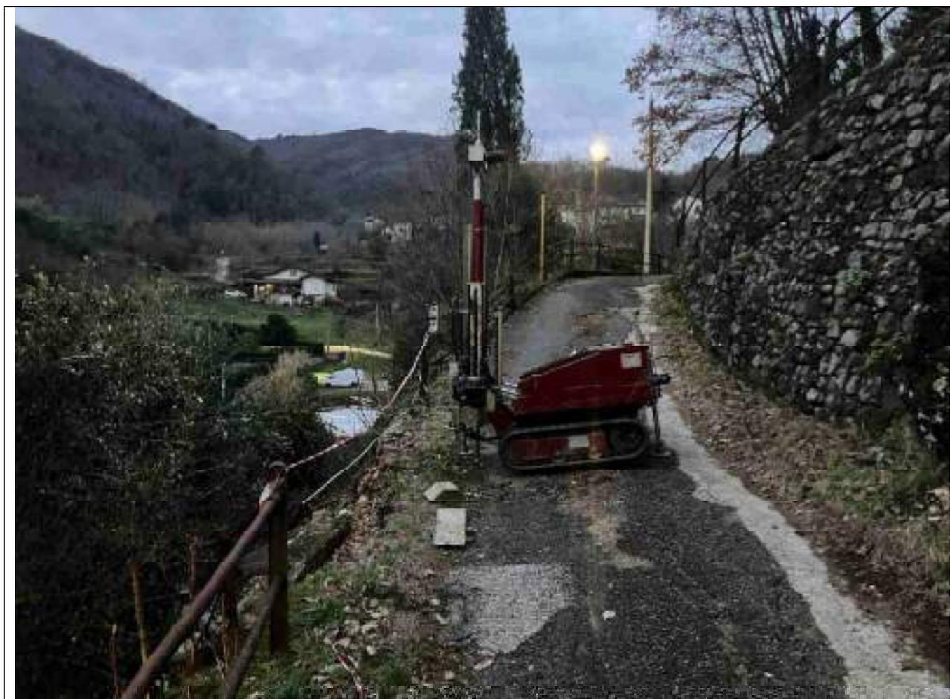
**Foto n.8** – Fasi di esecuzione della prova penetrometrica dinamica superpesante **DIN1**.
